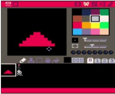
La réalisation proposée consiste en un jeu de tir. Trois sprites sont utilisés. Le premier (000) désigne la position du joueur à l'écran sous la forme d'un vaisseau (16x16 pixels). Le second (002) et le troisième (018) représentent respectivement un projectile (missile) et un ennemi (extraterrestre).
